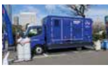
LPガス仕様移動電源車
