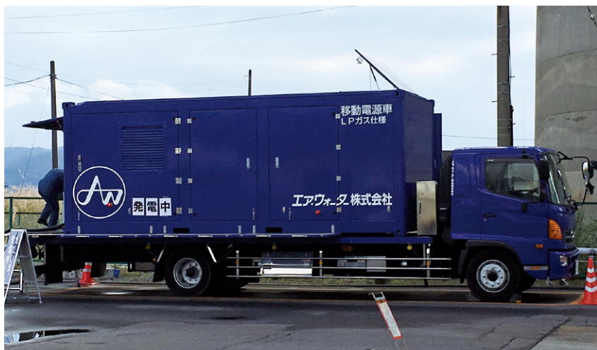
125KVA移動電源車。ローリー出荷にも対応。(エア・ウォーター(株)函館LPG基地にて)
