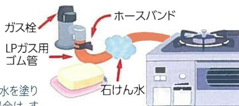
※ゴム管からのガスもれの点検は、石けん水を塗り泡が出るかで分かります。(泡が出た場合は、すぐに新しいゴム管に取替えてください。)また点検後はきれいに拭き取ってください。
