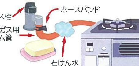
※ゴム管からのガスもれの点検は、石けん水を塗り泡が出るかで分かれます。(泡が出た場合は、すぐに新しいゴム管に取替えてください。)また点検後はきれいに拭き取ってください。
